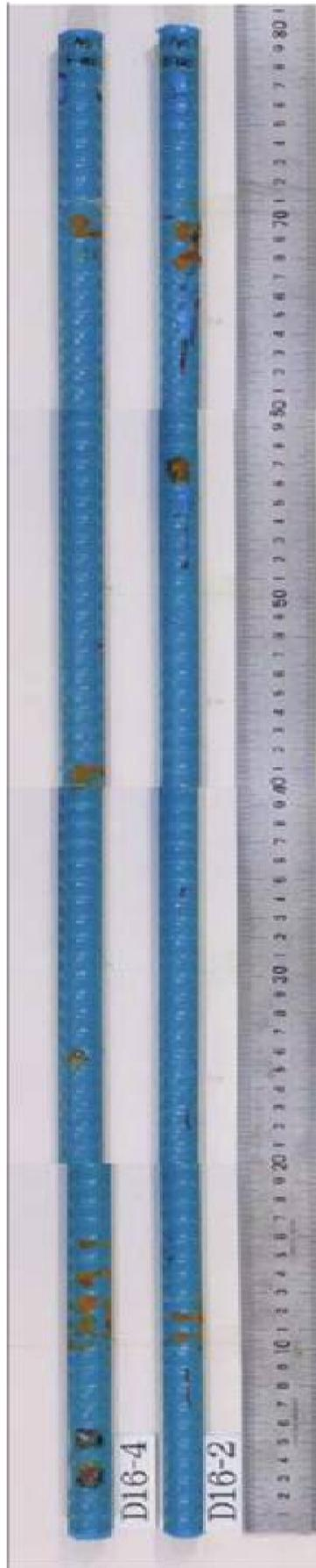
付図 2.5.20(b) D16-2,D16-4 塩水噴霧試験前の状況(下面)
