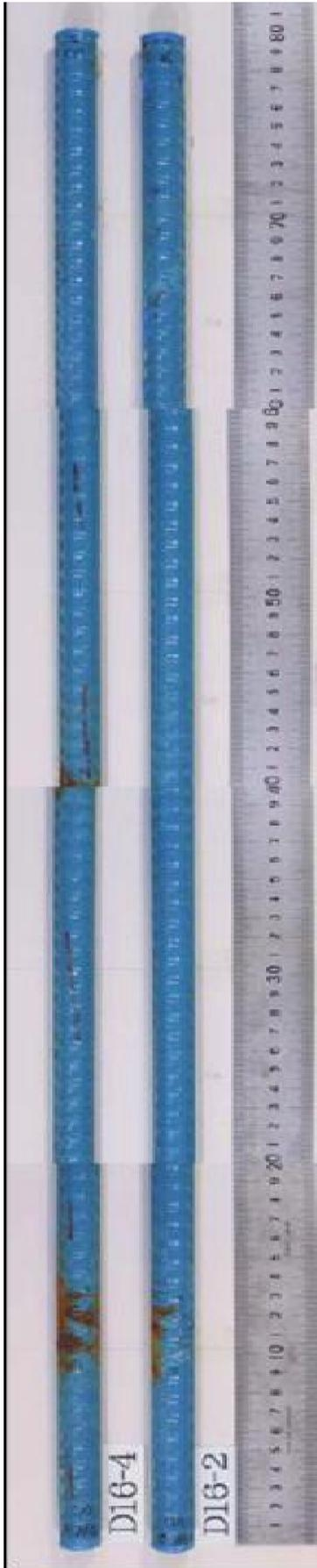
付図 2.5.20(a) D16-2,D16-4 塩水噴霧試験前の状況(上(噴霧)面)
