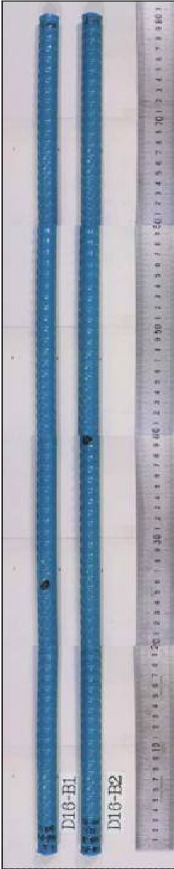
付図 2.5.18(a) D16-B1,D16-B2 塩水噴霧試験前の状況(上(噴霧)面)
