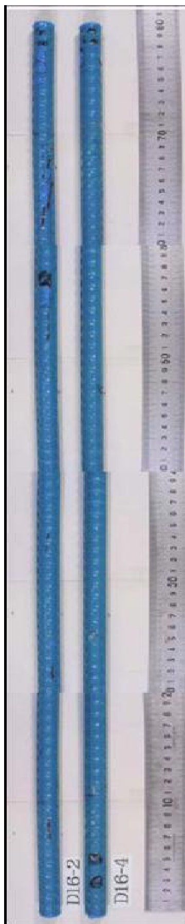
付図 2.5.17(b) D16-2,D16-4 塩水噴霧試験前の状況(下面)
