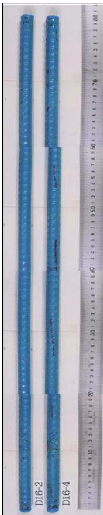
付図 2.5.17(a) D16-2,D16-4 塩水噴霧試験前の状況(上(噴霧)面)
