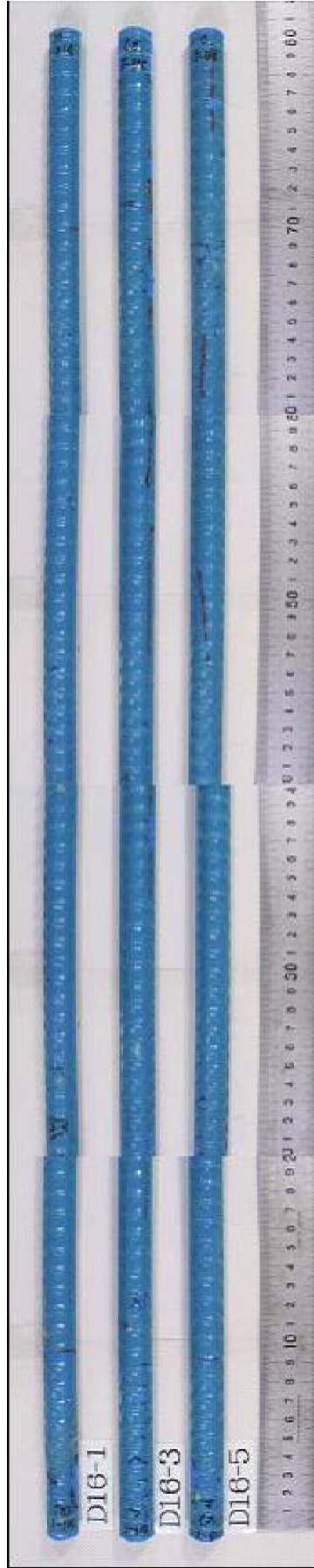
付図 2.5.16(b) D16-1,D16-3,D16-5 塩水噴霧試験前の状況(下面)
