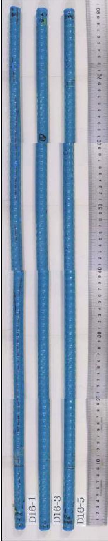
付図 2.5.16(a) D16-1,D16-3,D16-5 塩水噴霧試験前の状況(上(噴霧)面)
