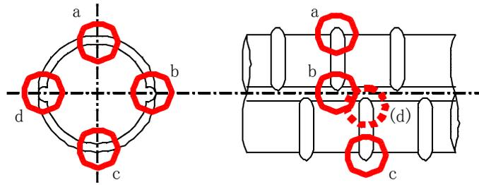
図 3.2.9(a) 塗膜厚の測定位置(鉄筋の断面方向)
