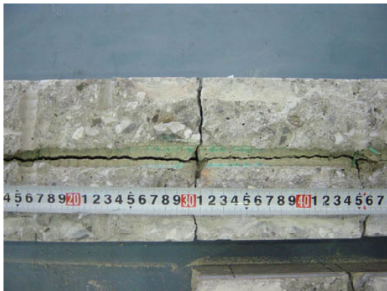
写真 2.5.1(a) 解体後の塗膜の付着状況の例
