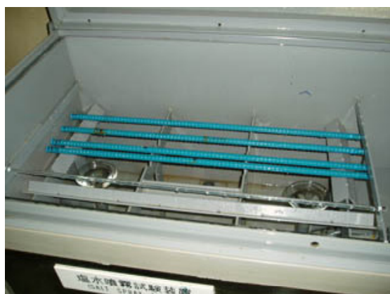
写真 2.3.1 塩水噴霧試験装置内への配置状況
