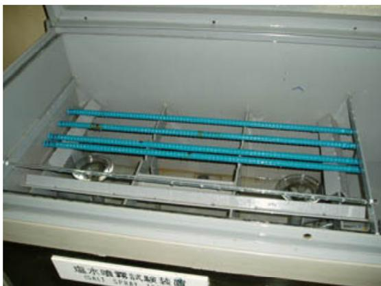
写真 2.3.1 塩水噴霧試験装置内への配置状況
