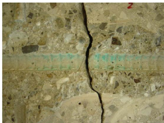
写真 2.5.1(b) 解体後の塗膜の付着状況の例
