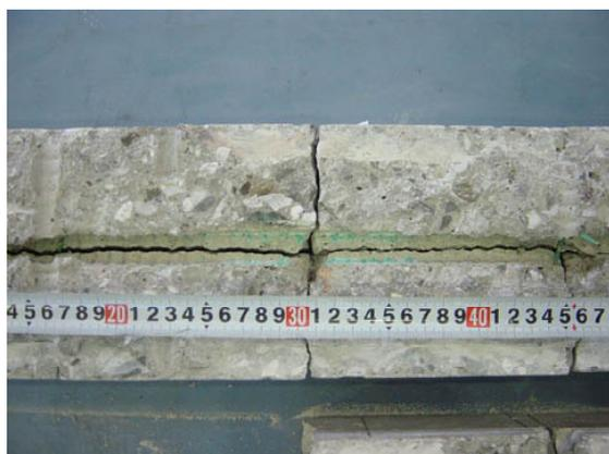
写真 2.5.1(a) 解体後の塗膜の付着状況の例
