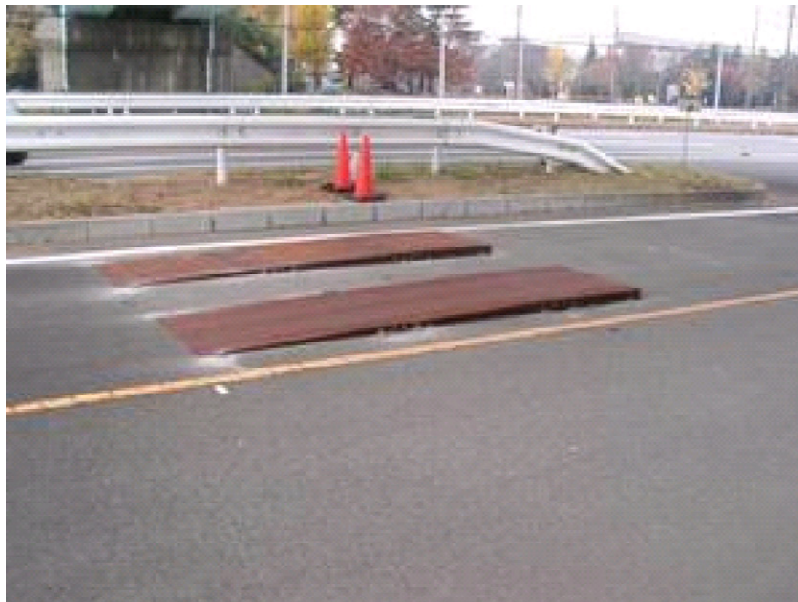
(a) 路上に設置されたサスペンション振動試験用ステップ
