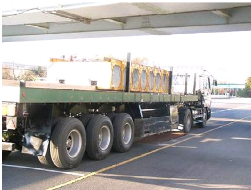
(a) 路上に設置されたサスペンション振動試験用ステップ
