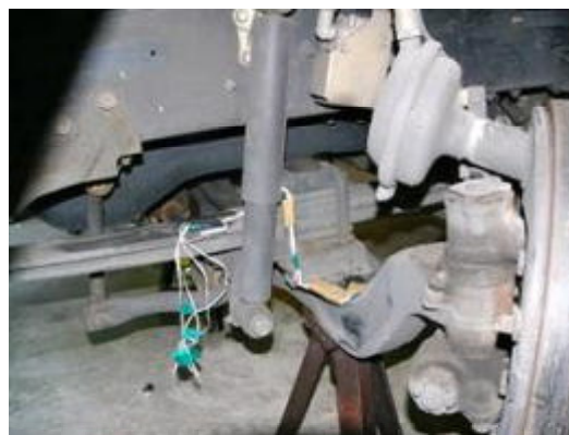
写真-2.2.2 ひずみゲージの貼付状況
