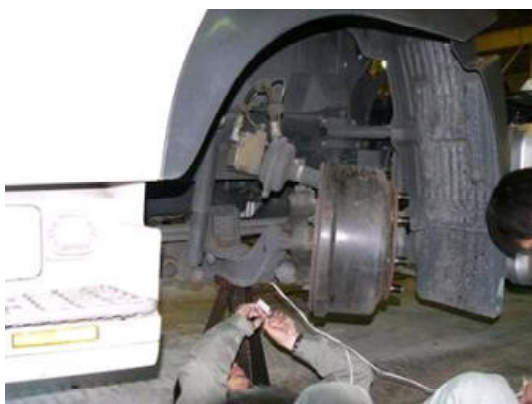
写真-2.2.1 ひずみゲージの貼付作業
