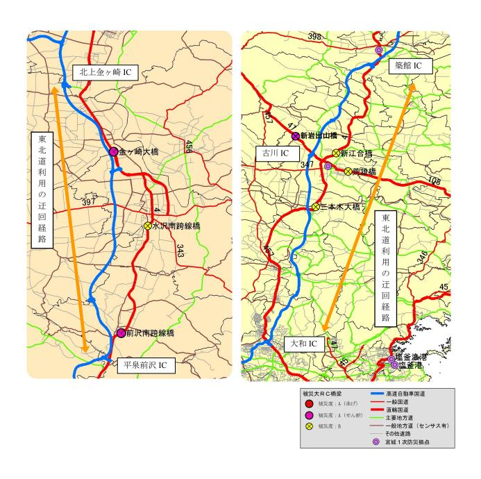
図 5-4 国道 4 号上の被災橋梁迂回経路
