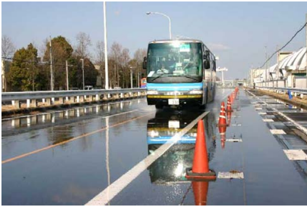
写真-1.2.2.1 試験状況 (実験施設による散水、密粒度アスファルト舗装)
