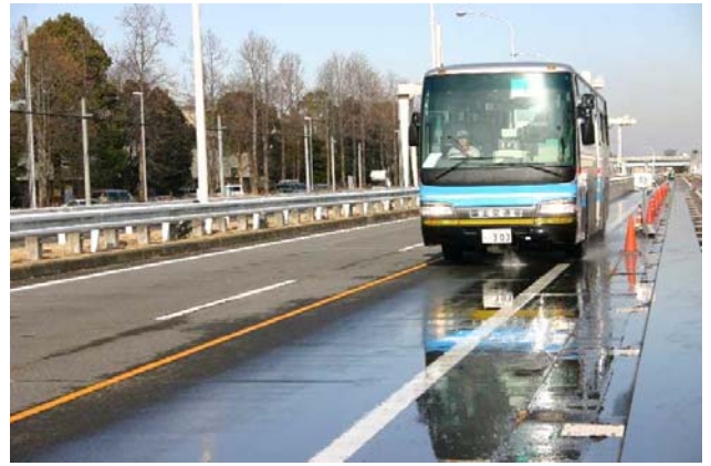
写真-1.2.2.2 試験状況 (自力散水、密粒度アスファルト舗装)
