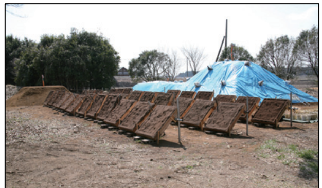
写真-1 表土を保存した盛土(奥)と植生基材吹付工を施した木箱(手前)
