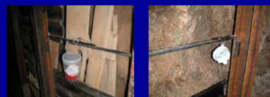
温湿度計の設置状況
