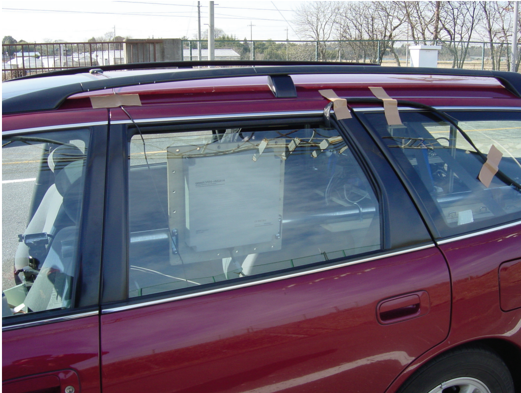
図 6-48 タグアンテナ取付け状況（車外から）
