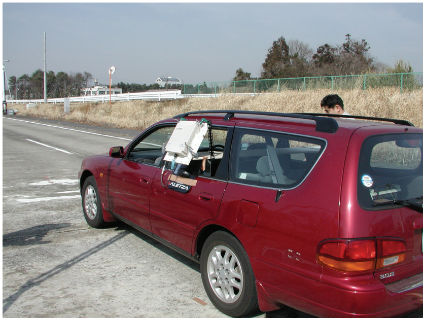
図 6-30 アンテナ取付け状況
