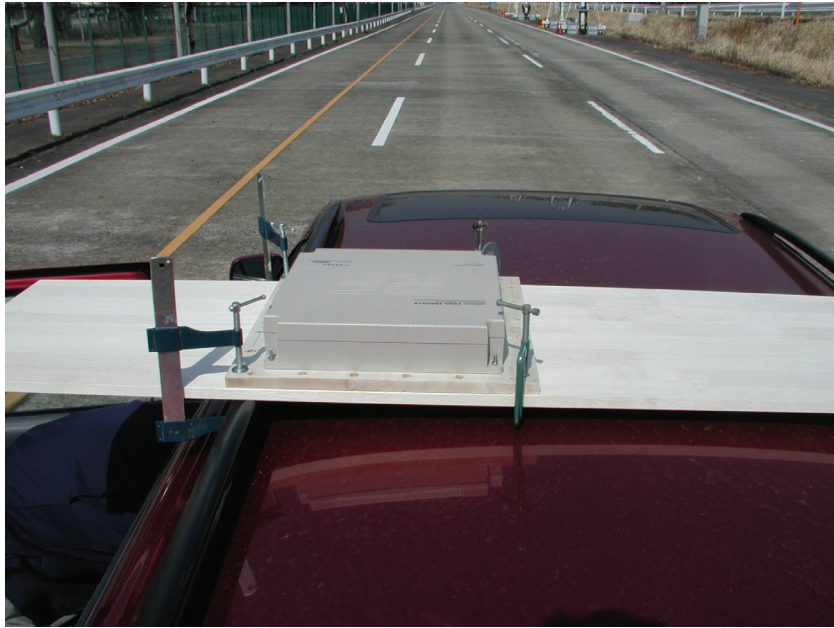
図 6-29 アンテナ取付け状況
