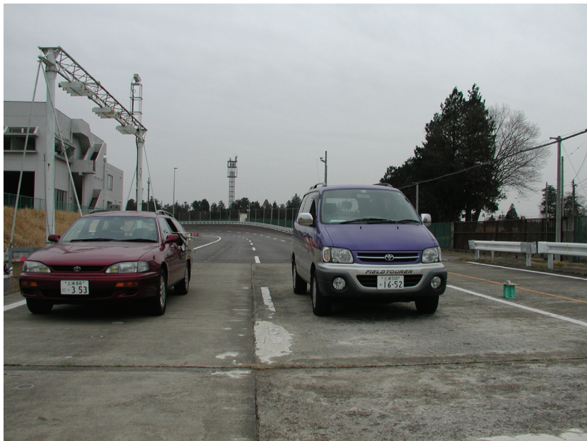
図 6-32 他車による遮蔽試験状況
