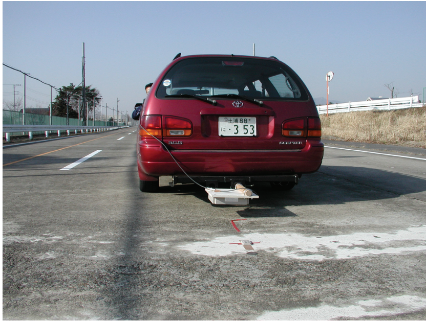
図 6-31 アンテナ取付け状況
