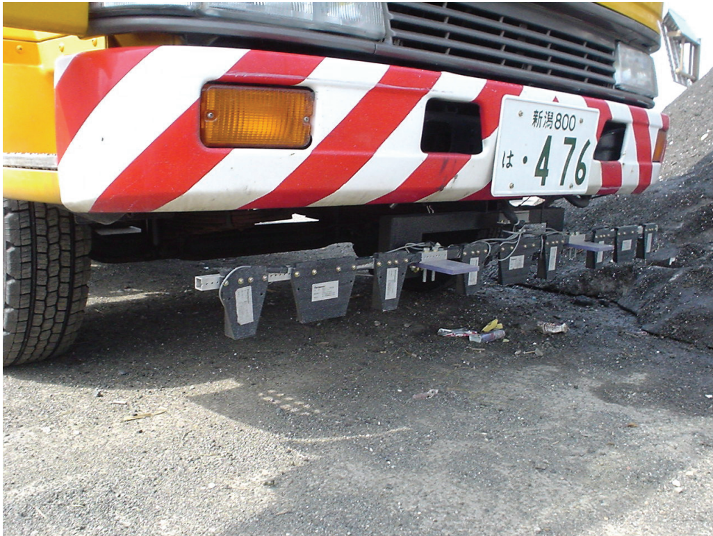
図 5-6 薬剤散布車への位置特定機器の設置状況（マーカセンサ横方）
