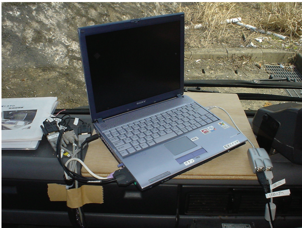
図 5-2 薬剤散布車への位置特定機器の設置状況（ノート PC）
