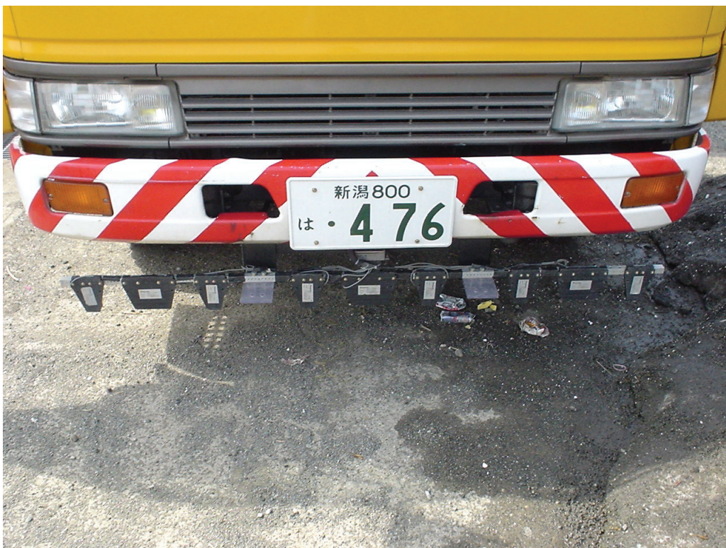
図 5-5 薬剤散布車への位置特定機器の設置状況（マーカセンサ前方）
