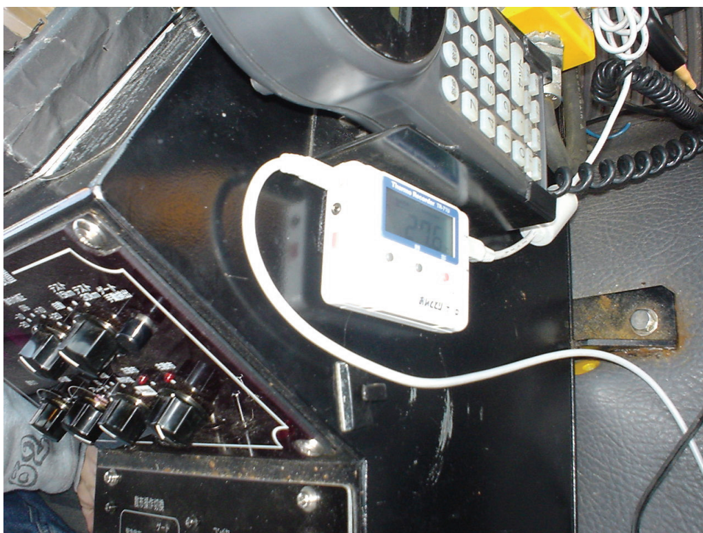
図 5-10 薬剤散布車への散布支援機器の設置状況（おんどとり）
