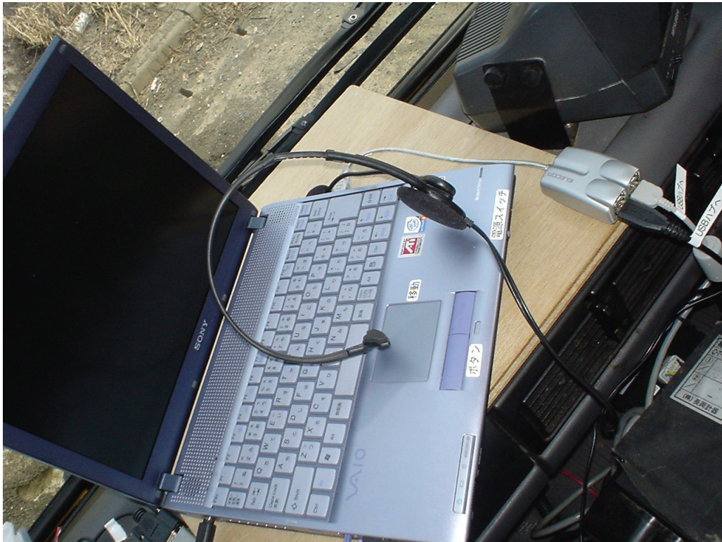
図 5-11 薬剤散布車への散布支援機器の設置状況（USB ハブとマイク）
