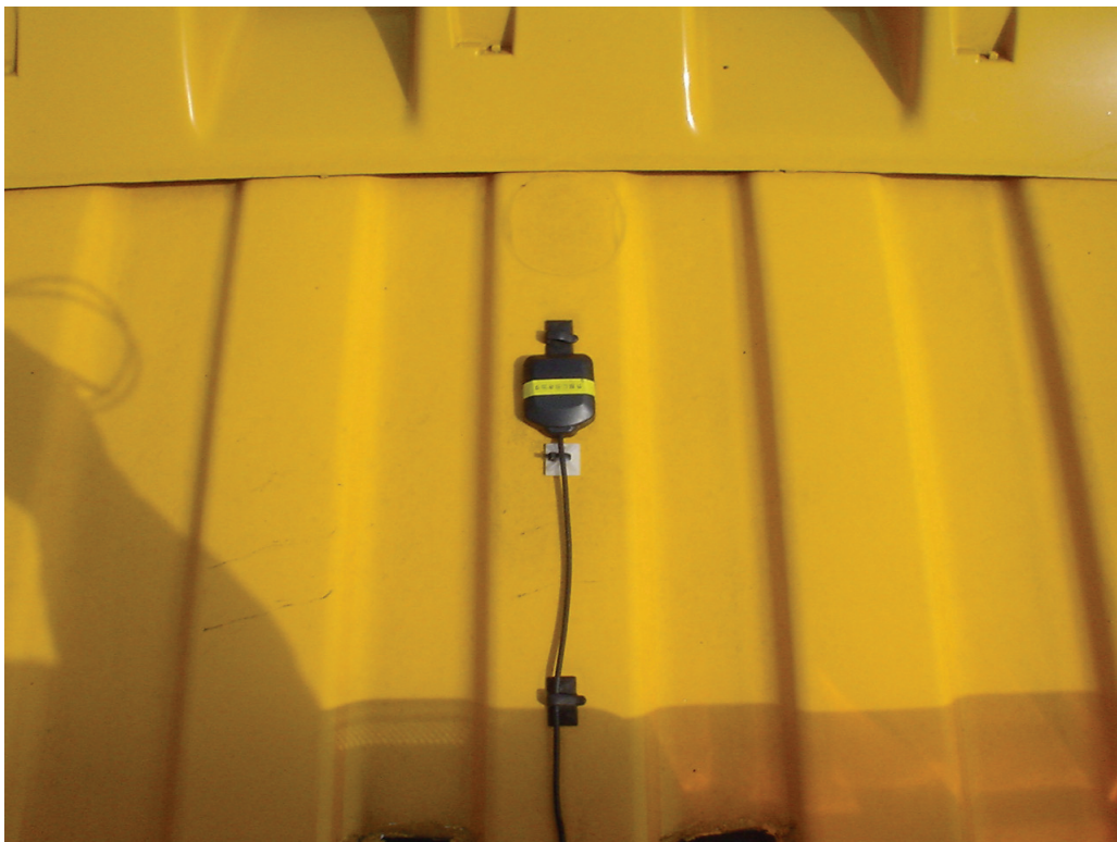
図 5-7 薬剤散布車への位置特定機器の設置状況（GPS アンテナ）
