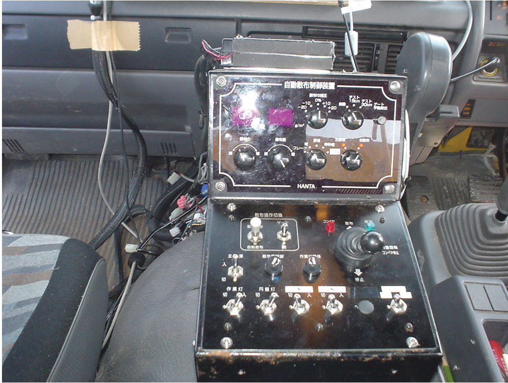
図 5-9 薬剤散布車への散布支援機器の設置状況（自動散布制御装置）
