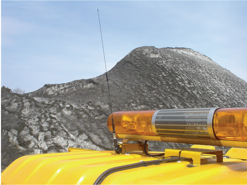
図 5-8 薬剤散布車への位置特定機器の設置状況（FM アンテナ）
