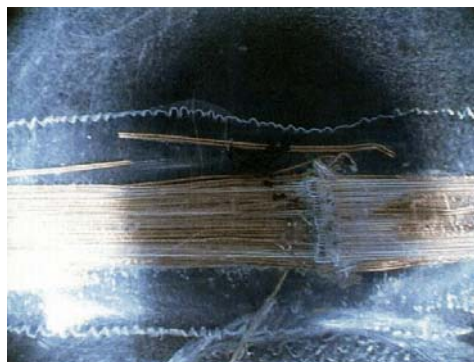
写真-2 アンテナコイルの断線状況
