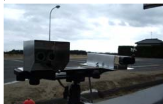
左側:超音波センサーユニット(80W×50H×100Dmm)
