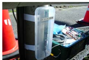
磁気センサーユニット(250W×90H×30Dmm)
