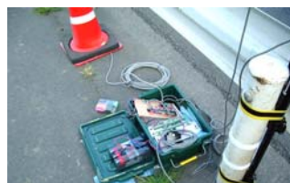
収録装置(400W×280D×190Dmmコンテナボックス)
