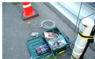
収録装置(400W×280D×190Dmmコンテナボックス)
