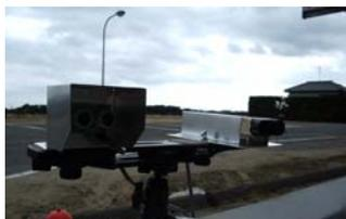
左側:超音波センサーユニット(80W×50H×100Dmm)
