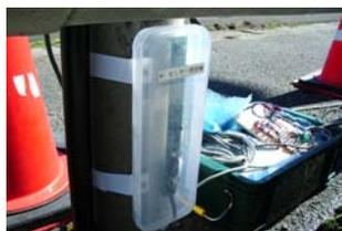
磁気センサーユニット(250W×90H×30Dmm)
