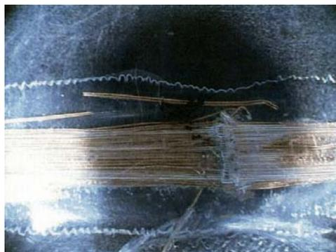
写真-2 アンテナコイルの断線状況
