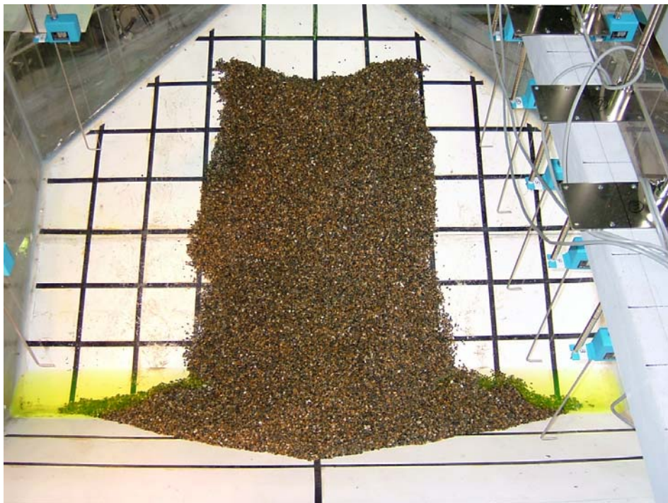
写真－2 堆砂形状 (case8)
