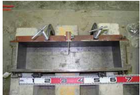
写真 8.1 破壊エネルギー試験型枠
