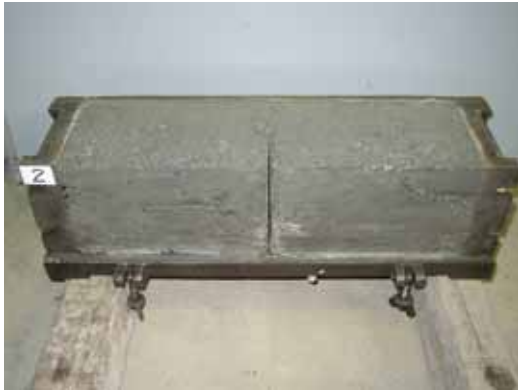
写真 8.3 破壊エネルギー試験供試体
