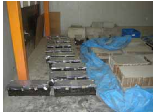
写真 8.4 封緘養生状況
