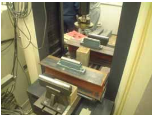
写真 8.5 3点曲げ試験装置
