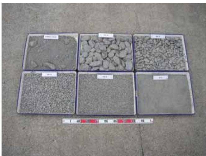
写真 4.3.1 CSG材：掘削ズリ（千枚岩）( )
