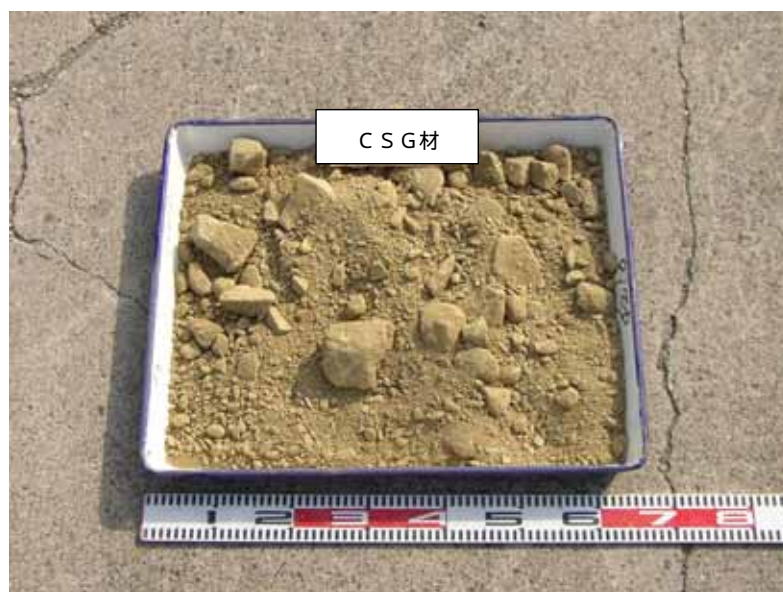
写真4.2.1 現地発生材：掘削ズリ（分級前）（ ）
