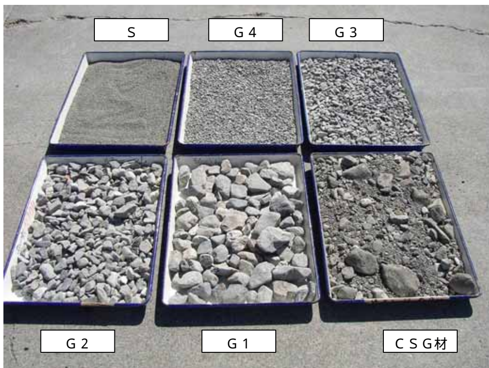
写真 4.2.4 現地発生材：河床砂礫 B ( )
