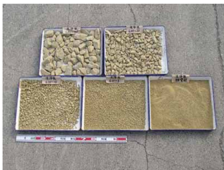
写真4.2.2 現地発生材：掘削ズリ（分級後）（ ）
