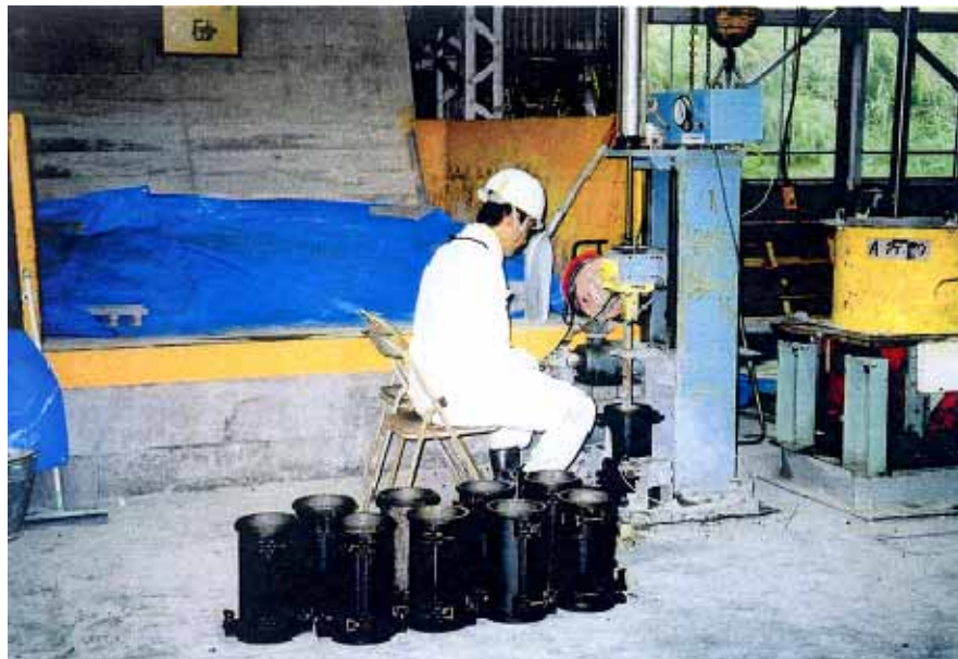
写真 1.3 標準供試体作製状況
