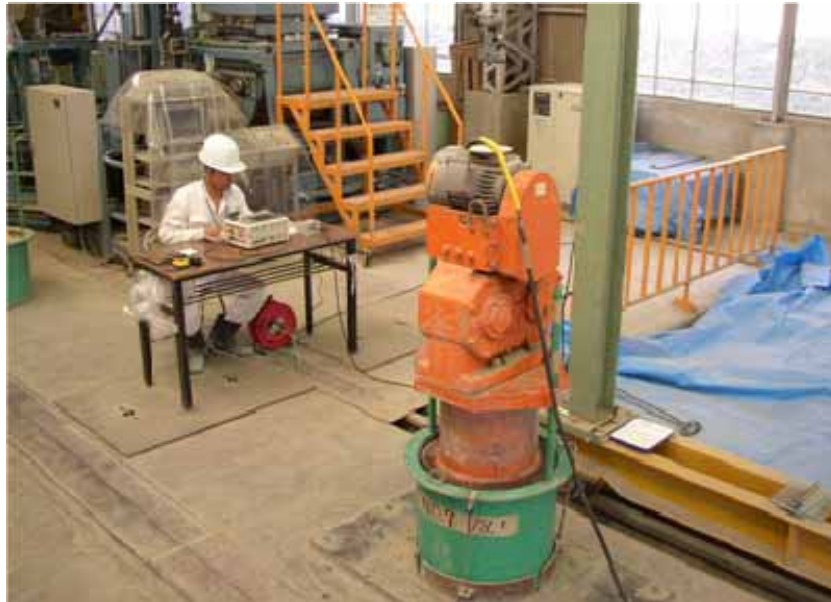
写真 1.4 大型供試体作製状況
