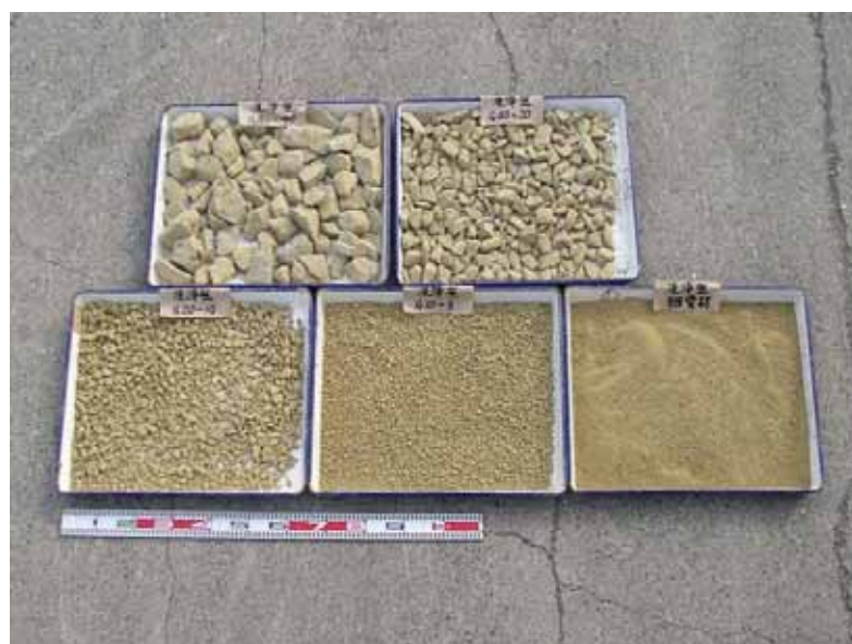
写真4.2.2 現地発生材：掘削ズリ（分級後）（ ）
