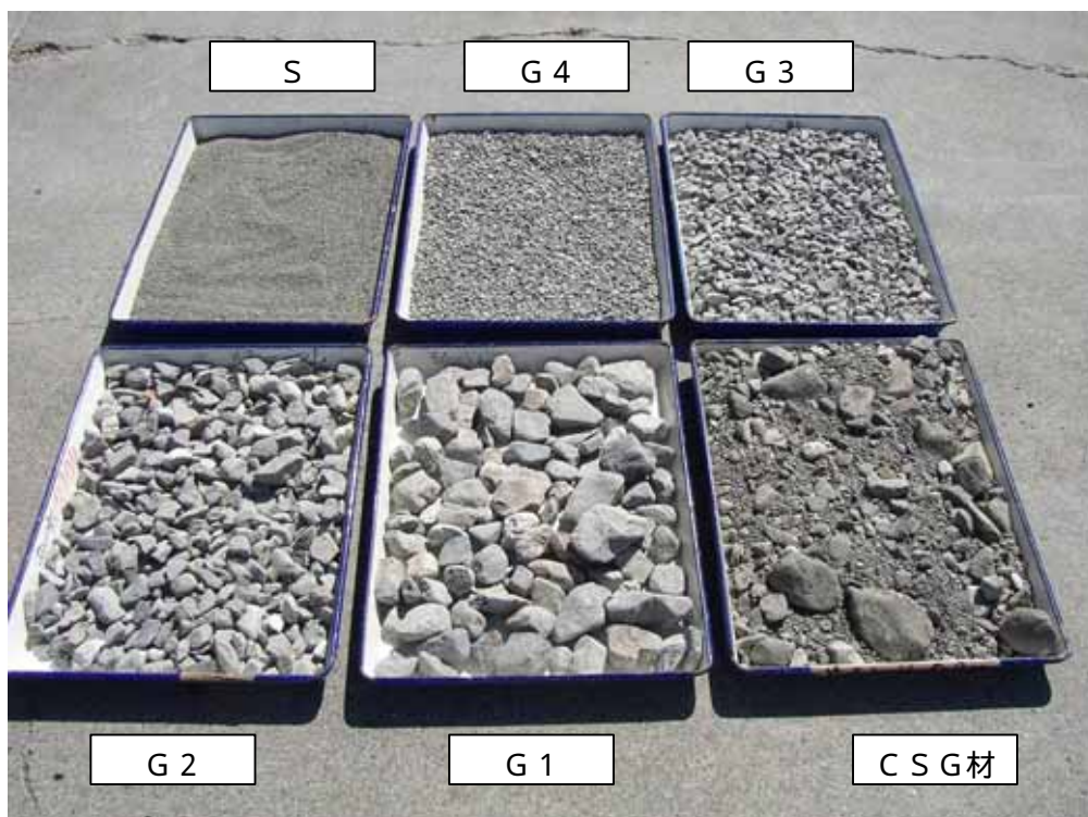
写真 4.2.4 現地発生材：河床砂礫 B ( )
