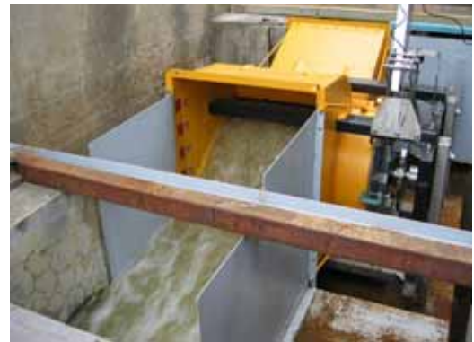
写真 - 2 水車下流部の流況
