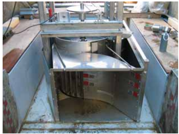
(b) 鉛直軸型水車（縦置き）
