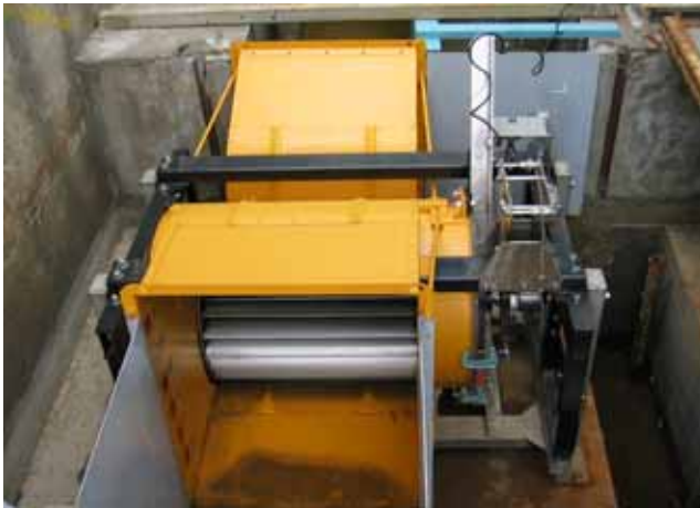
(a) 水平軸型水車（横置き）
