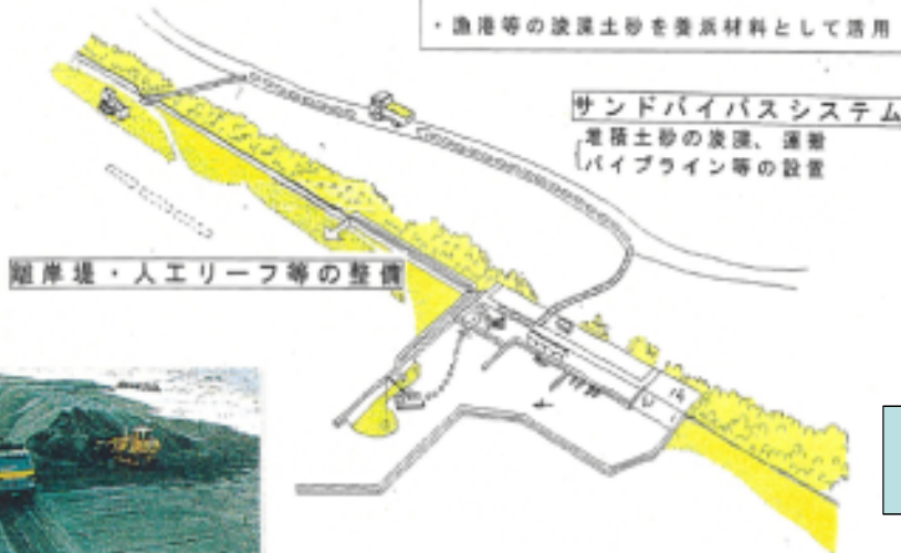
サンドバイパスのための土砂採取 (富崎海岸; 富山県)
