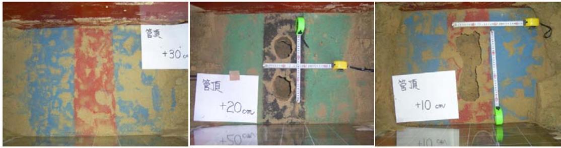
写真4 caseA (管軸方向・豊浦砂・地下水位20cm)のゆるみ・空洞進行状況
