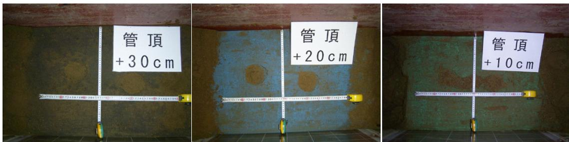
写真8 caseH (管周方向・山砂・地下水位80cm)のゆるみ・空洞進行状況
