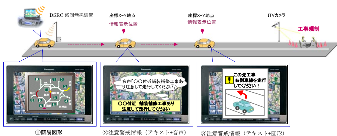
図 5.1-3 注意警戒情報の提供（工事規制情報の表示処理）イメージ（案）
