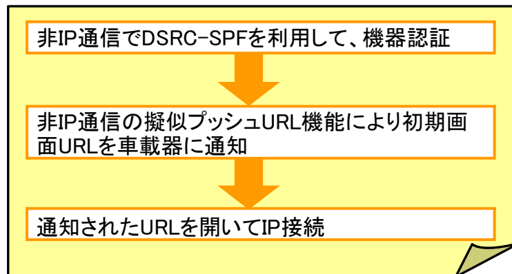
図 ①DSRC-SPFによるIP通信時の認証の流れ
