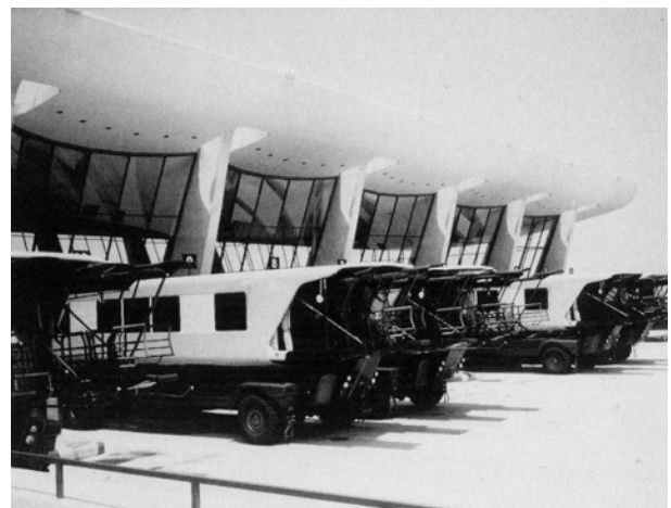
写真-8 ダレス国際空港モービルラウンジ 96)
