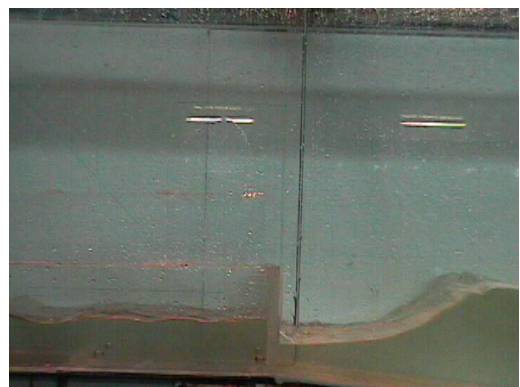
写真-1 (a) 直立壁越波実験 (Case4)
