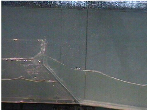
写真-1(b) 傾斜壁 (1:1) 越波実験 (Case15)
