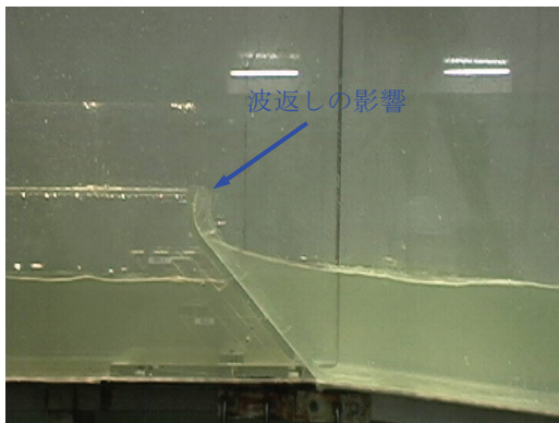
写真-1(c) 傾斜壁 (1:1) 越波実験 (Case31)
