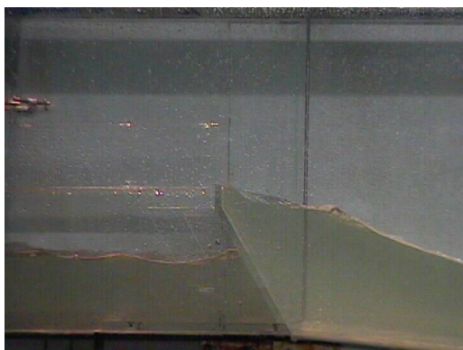
写真-1(e) 傾斜壁 (1:1/2) 越波実験 (Case43)
