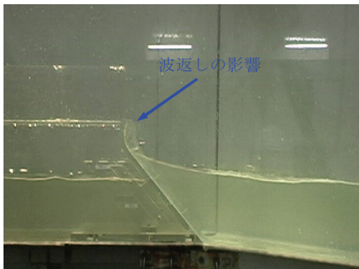
写真-1(c) 傾斜壁 (1:1) 越波実験 (Case31)
