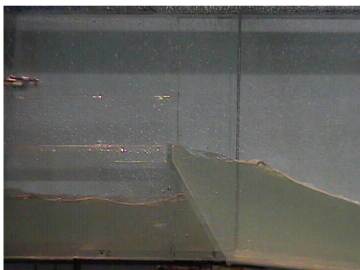
写真-1(e) 傾斜壁 (1:1/2) 越波実験 (Case43)
