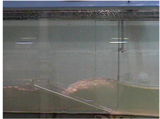
写真-1(f) 傾斜壁 (1:3) 越波実験 (Case58)
