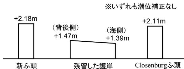
図-3.11 新ふ頭、残留した護岸及び Closenburg ふ頭の天端高さの比較
