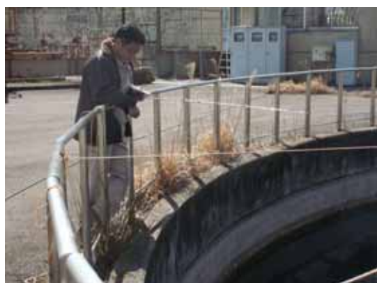
吹き流しによる流向確認状況
