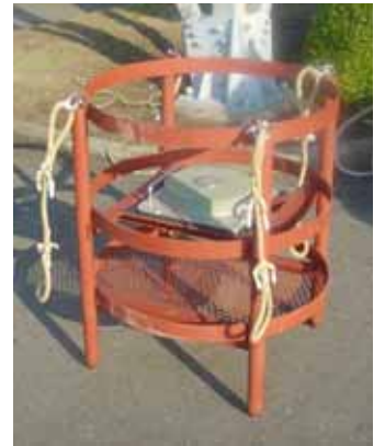
写真 19 散気装置（水中沈設）
