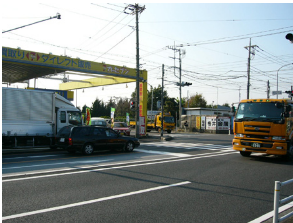
図-2・4(4) 事故発生要因事例 (A3) [構造物によって、横断歩道が見にくい]
