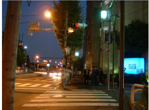
図-2・4(3) 事故発生要因事例 (B2) [樹木によって、横断歩道への照明が遮られる]
