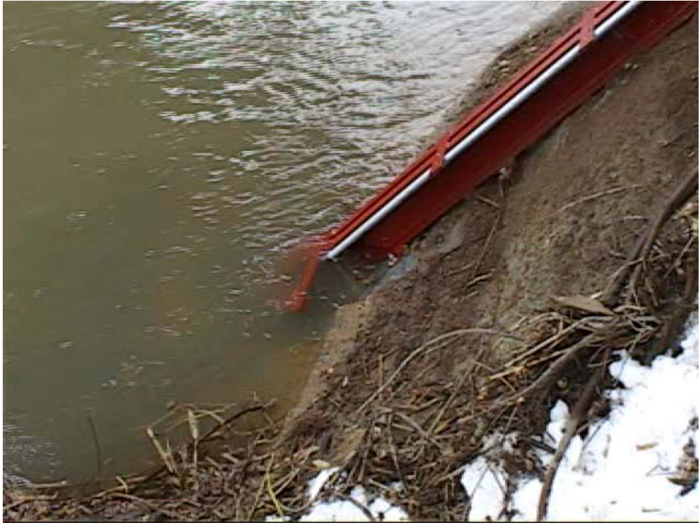
写真一 濁度計の設置状況（平成 17 年 2 月 23 日撮影）
