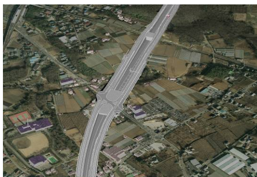
図3-31 堀割構造道路と側道の3次元モデル
