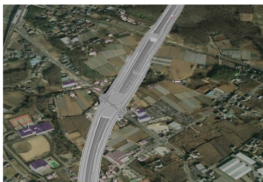
図 3-31 堀割構造道路と側道の 3 次元モデル
