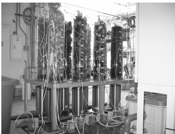
写真－1 カラム通水実験装置の組立状況
