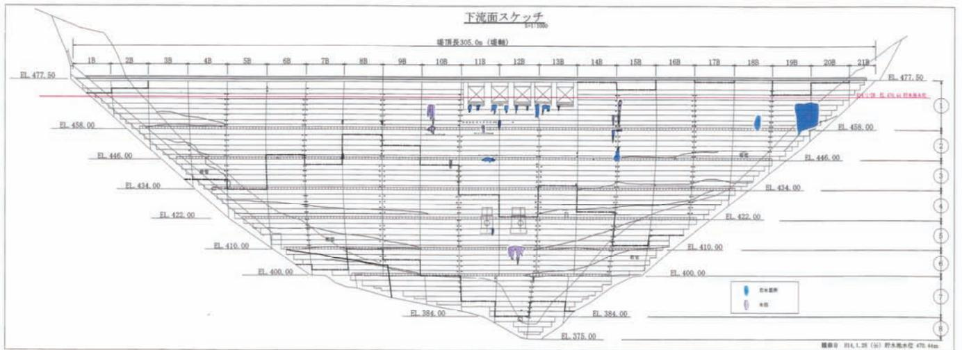
図 2.3 下流面漏水状況スケッチ 平成 14 年 1 月 28 日
