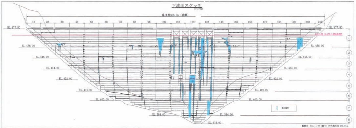
図 2.2 下流面漏水状況スケッチ 平成 13 年 11 月 9 日
