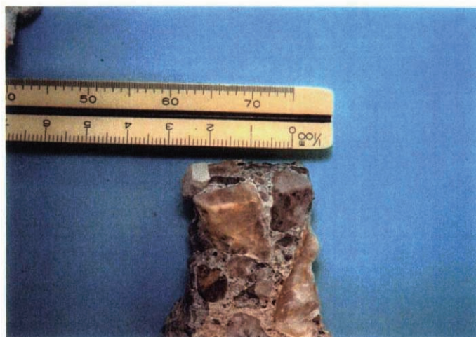
同上溶食面 斜上方より 左端部は淡緑灰 の安山岩系骨材 (溶食を認めず)
