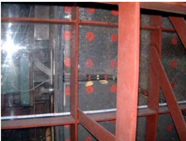
(b) 二重遮水シート上端部（実験前：ケースB-3）
