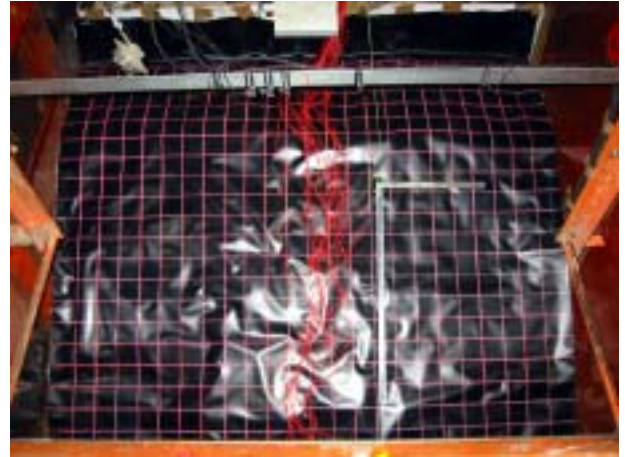
(c) 実験前の遮水シート (ケースA-2)
