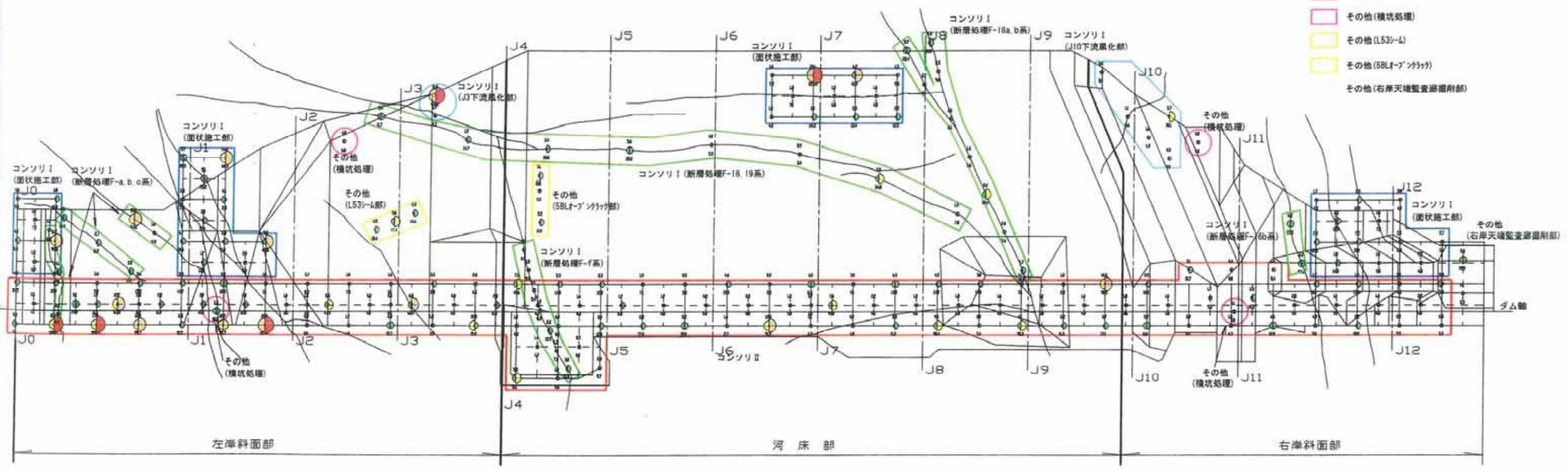
図-5.1.21(1) コンソリデーショングラウチング実績図(1ステージ全孔)
