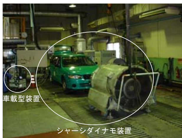
図1 車載型装置とシャーシダイナモ装置による排ガス計測
