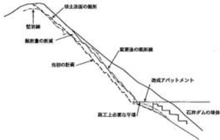
図 - 6.2.7 左岸掘削形状
