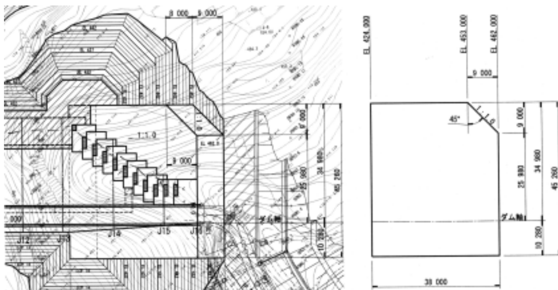
図－4.10.21 隅切り形状概念図（スロープ形状）
