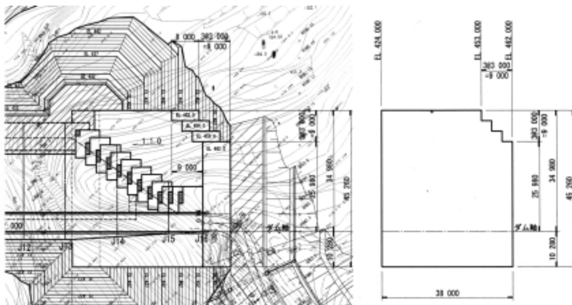
図－4.10.22 隅切り形状概念図（階段形状）
