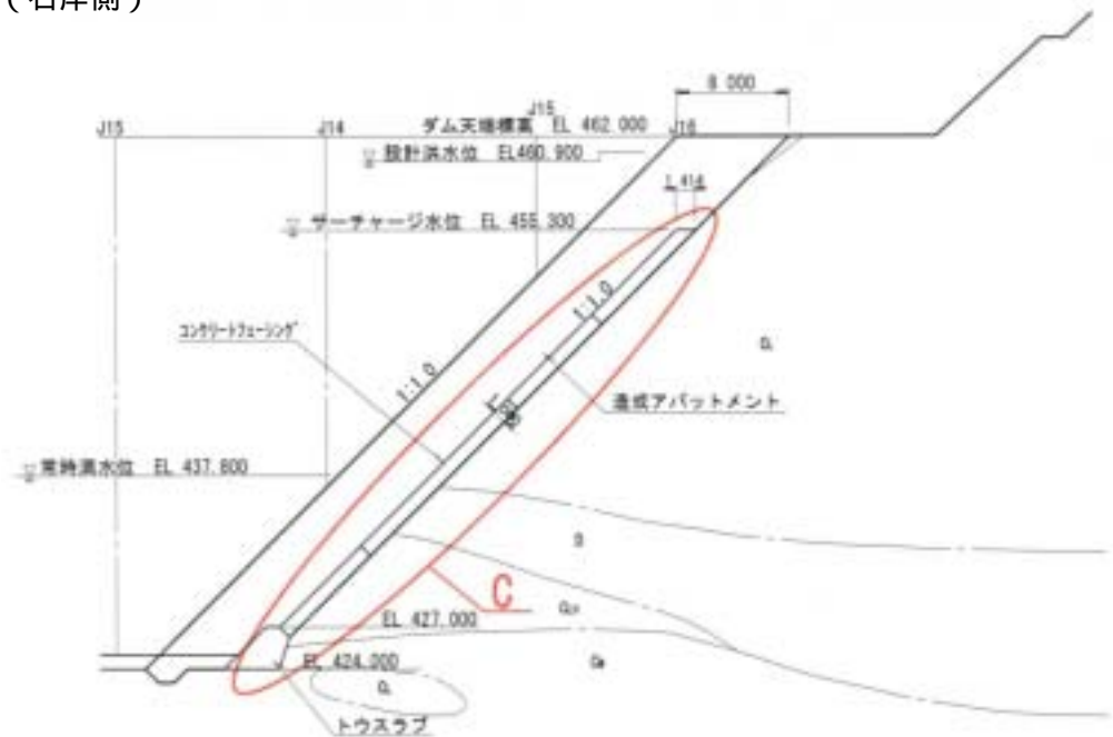
図 - 4.10.12(2) 右岸造成アバットメント接合部上流面図 S=1/600
